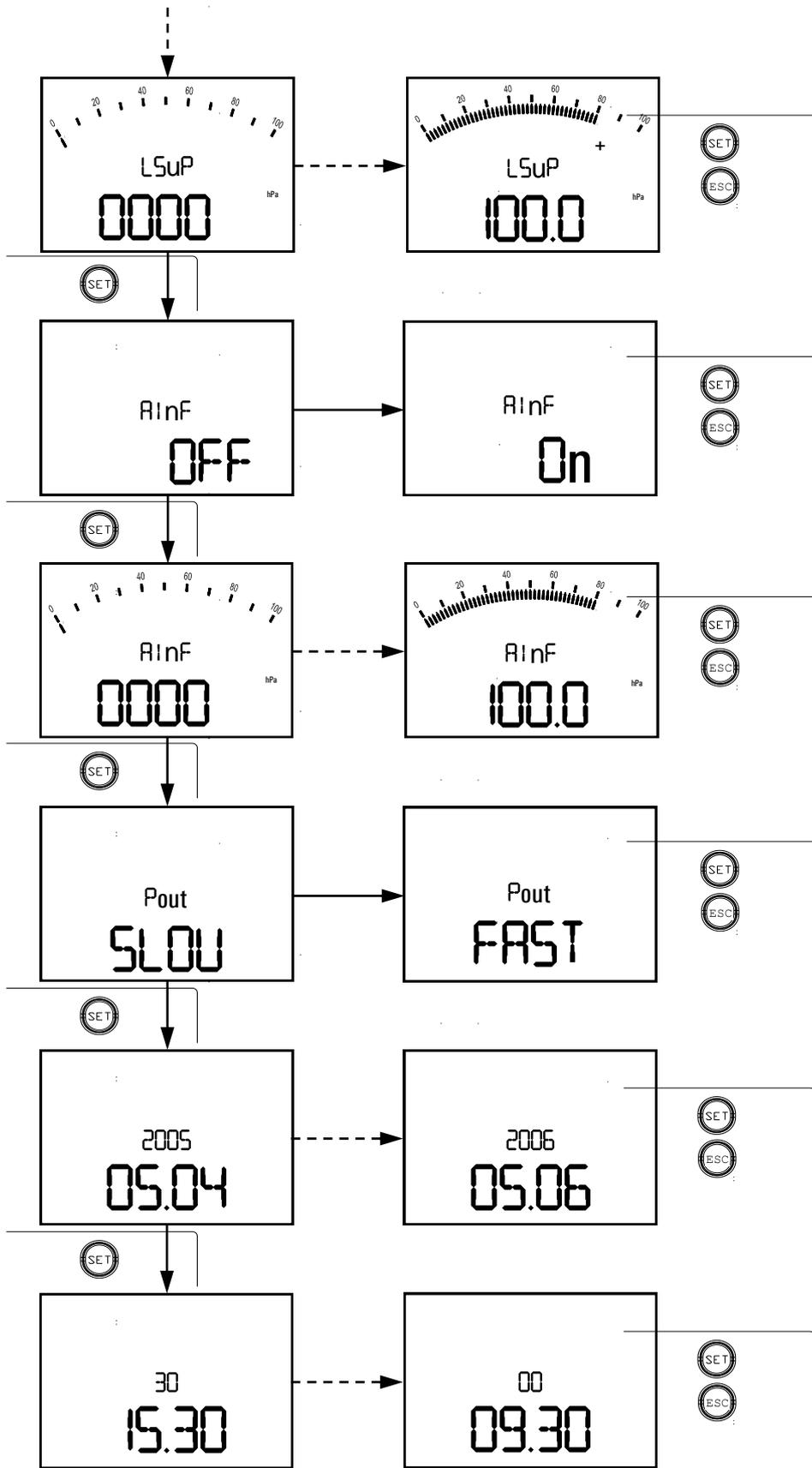
Настройте порог срабатывания сигнализации по превышению установленного порога срабатывания). Возможно установить десятые доли. Кнопка 'UNIT' изменяет единицы измерения настройки порога.
