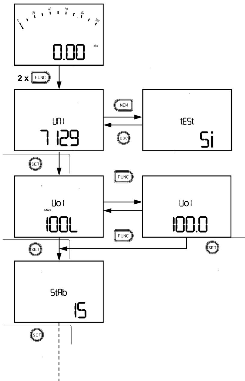
Нажмите 2 раза на кнопку 'FUNC', чтобы выбрать тест на герметичность в соответствии с нормой UNI 7129-1:2015.
